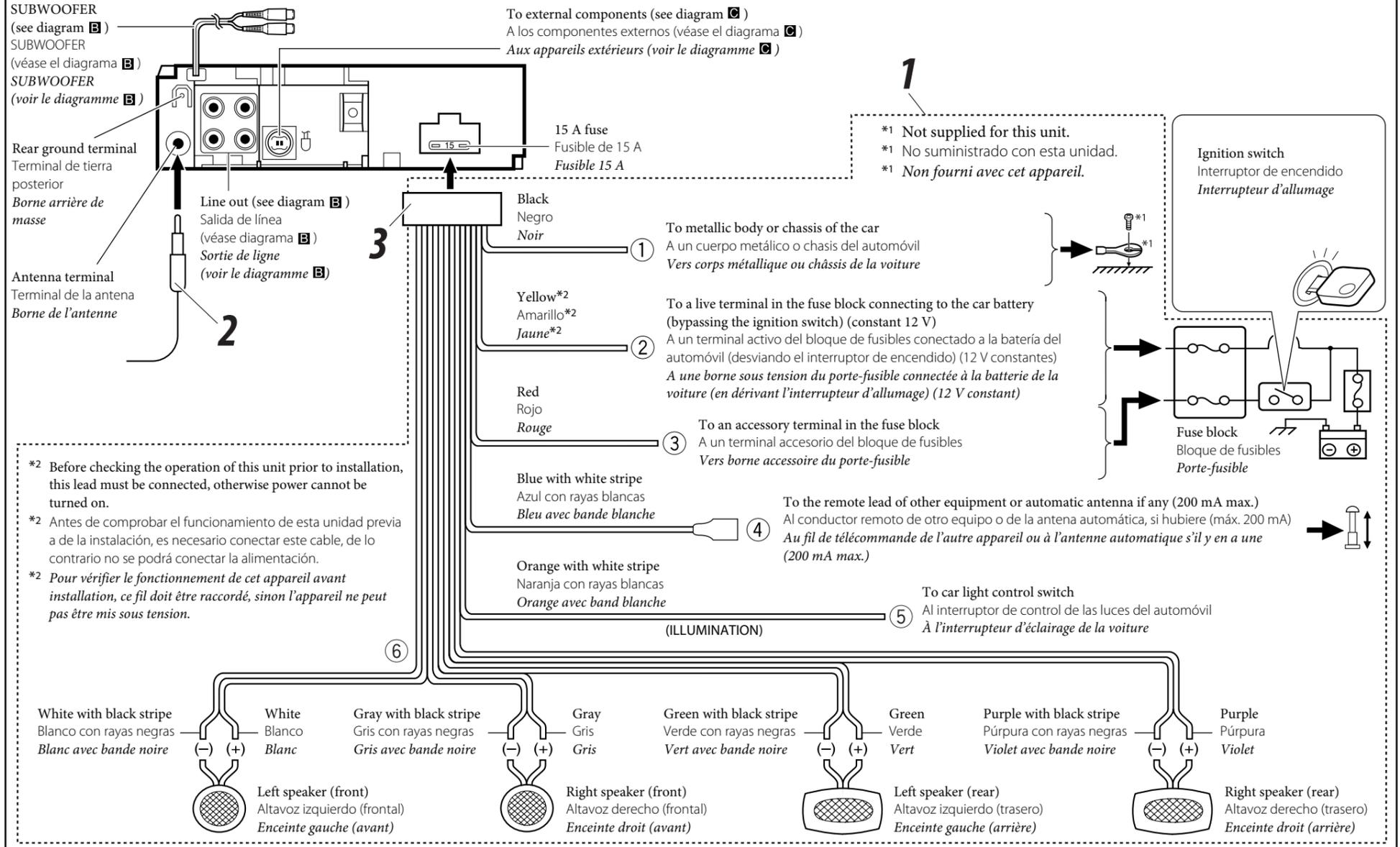
**B Connecting the external amplifiers and/or subwoofer / Conexión de los amplificadores y/o subwoofer externos / Connexion d'amplificateurs extérieurs et/ou d'un caisson de grave**
