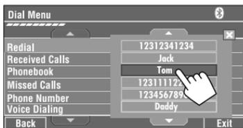
Quando se utiliza el control remoto, usted podrá visualizar en cualquier momento la lista <Redial > (excepto cuando se utiliza la Zona Dual).
