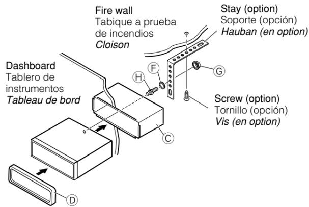
Install the receiver at an angle of less than 30°. Instale la unidad a un ángulo de menos de 30°. Installez l'appareil avec un angle de moins de 30°.
