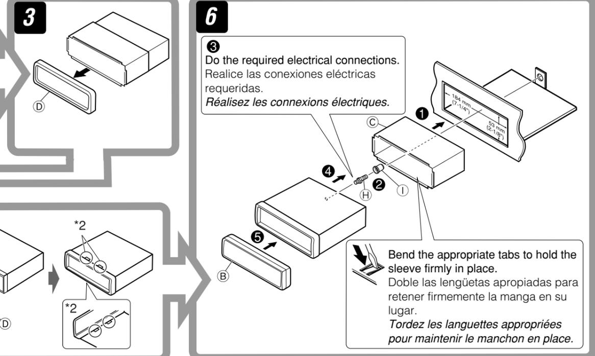
**③** Do the required electrical connections. Realice las conexiones eléctricas requeridas. Réalisez les connexions électriques.
