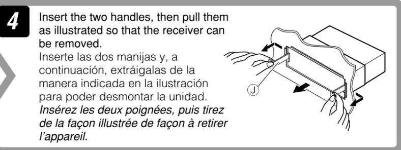
Insert the two handles, then pull them as illustrated so that the receiver can be removed. Insérez les deux poignées, puis tirez de la façon illustrée de façon à retirer l'appareil.
