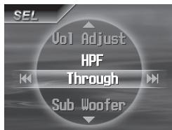
Ajuste la frecuencia de corte para los altavoces delanteros/traseros de acuerdo con el ajuste del subwoofer.
