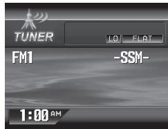
Se visualiza “-SSM-” hasta que finalice el preajuste automático.
