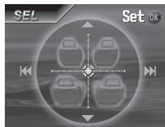
Ajuste el fader—balance de salida de altavoz, entre los altavoces delanteros y traseros.
