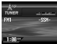
“-SSM-” apparaît jusqu'à ce que le préréglage automatique soit terminé.
