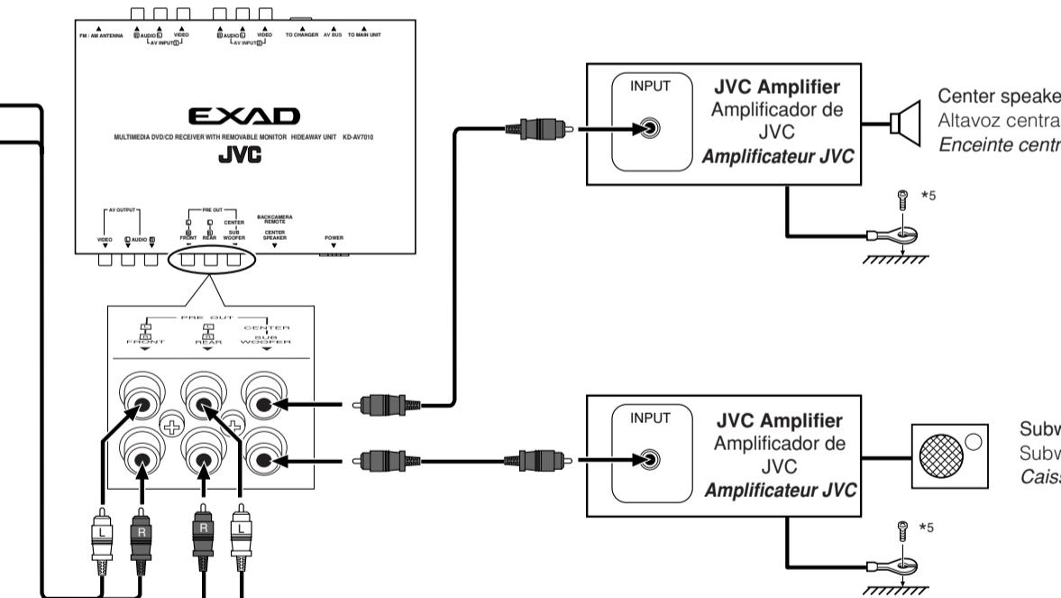
\*5 Fije firmemente el cable de tierra a la carrocería metálica o al chasis—a un lugar no cubierto con pintura (si está cubierto con pintura, quitela antes de fijar el cable). De lo contrario, se podrían producir daños en la unidad.
