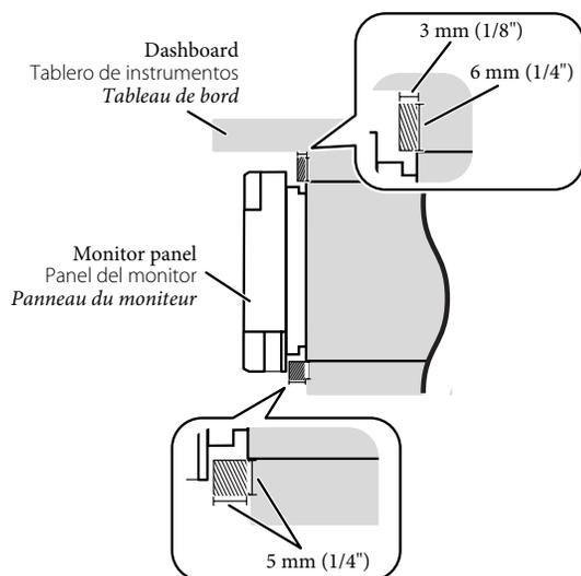
Trim plate is detached on this illustration for explanation. Para fines explicativos, se ha retirado la placa de guarnición en esta ilustración.
