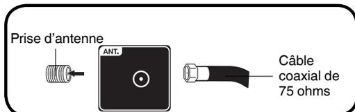
Raccordez le câble de 75 ohms de l'antenne combinée VHF/UHF à la prise d'antenne.
