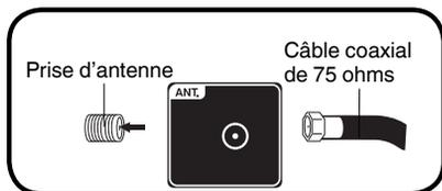
Si vous êtes abonné aux services de base du câble sans convertisseur/débrouilleur, branchez directement le câble coaxial de 75 ohms sur la prise d'antenne se trouvant à l'endos du téléviseur.
